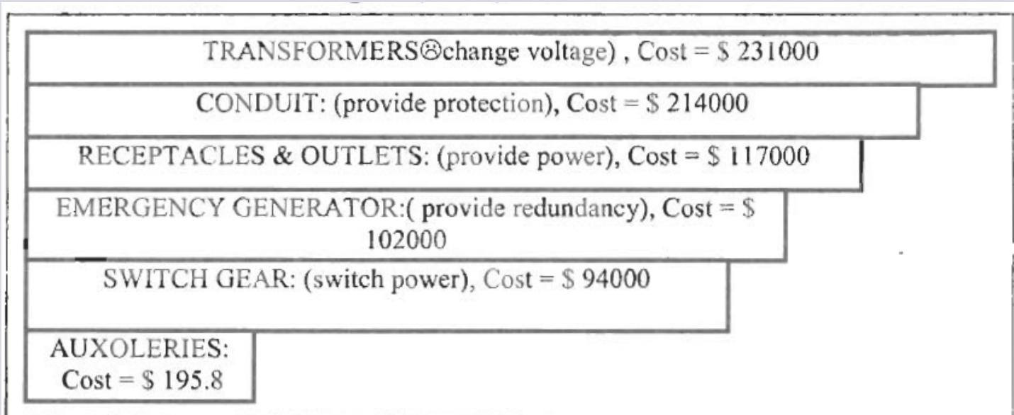
الشكل (14/7) التحليل الوظيفي لنظام توزيع حمل التكييف (وحدة القياس = طن تبريد)
